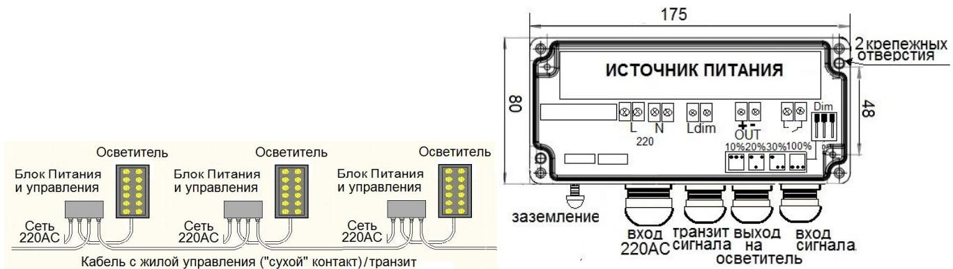
Рекомендуемая высота установки осветителей от 2 до 3 метров; расстояние между осветителями – от 10 до 12 метров, в зависимости от юстировки (угла наклона к освещаемой поверхности). Для заземления корпуса блока питания и управления подсоединить заземляющий провод к выводному винту, закрепленному на корпусе Блока.
