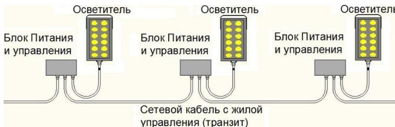
Рекомендуемая высота установки осветителей от 2 до 3 метров; расстояние между осветителями – от 10 до 12 метров, в зависимости от юстировки (угла наклона к освещаемой поверхности). Настройка осветителя и обслуживание во время эксплуатации не требуются. Для заземления корпуса Блока питания и управления подсоединить заземляющий провод к выводному винту, закрепленному на корпусе Блока.
