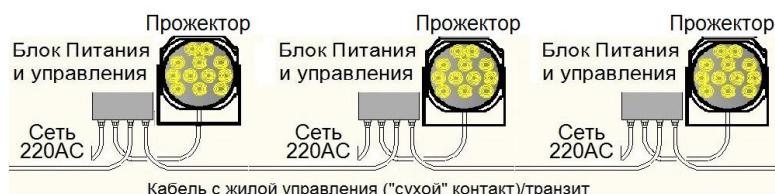
Схема соединения прожекторов
